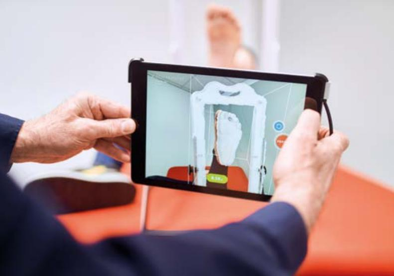
**Bei der Arbeit mit unmodifizierten Daten** wird entweder der möglichst lotgerecht positionierte Fuß der Patient:innen oder das unbearbeitete Gipspositiv gescannt. Diestellungs- und Formkorrektur wird dann von den Techniker:innen im proprio AFO Konfigurator durchgeführt.
